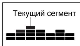
Профиль будет показывать текущую скорость или наклон в текущем сегменте. В конце каждого сегмента звучит сигнал, предупреждающий о переходе на следующий сегмент, который начнет мигать. Если для следующего сегмента запрограммированы другие скорость и наклон, то новые данные появятся на дисплее на несколько секунд. Беговая дорожка автоматически установит новые параметры скорости и/или наклона.
